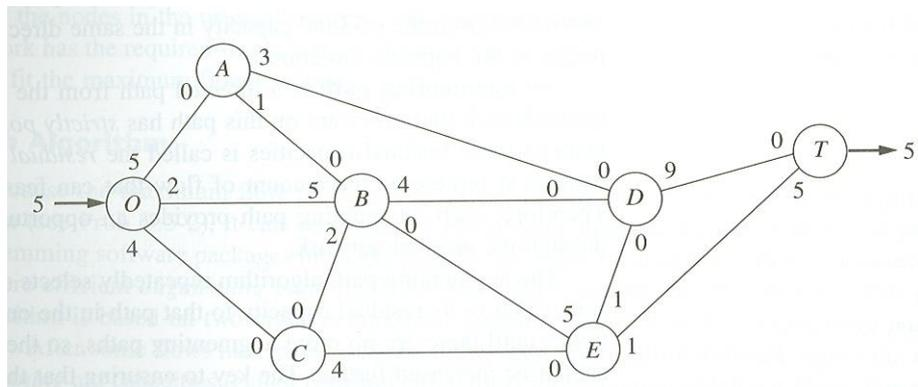
(iii) 選 augmenting path  $O \rightarrow A \rightarrow D \rightarrow T$ ，其最大容量（同一次）為  $\min\{5,3,9\} = 3$ 。我們便分配 3 個單位容量到這條 augmenting path：
